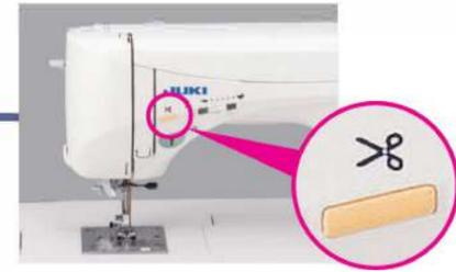
Il est aussi possible de couper les fils grâce au bouton en façade de la machine.
